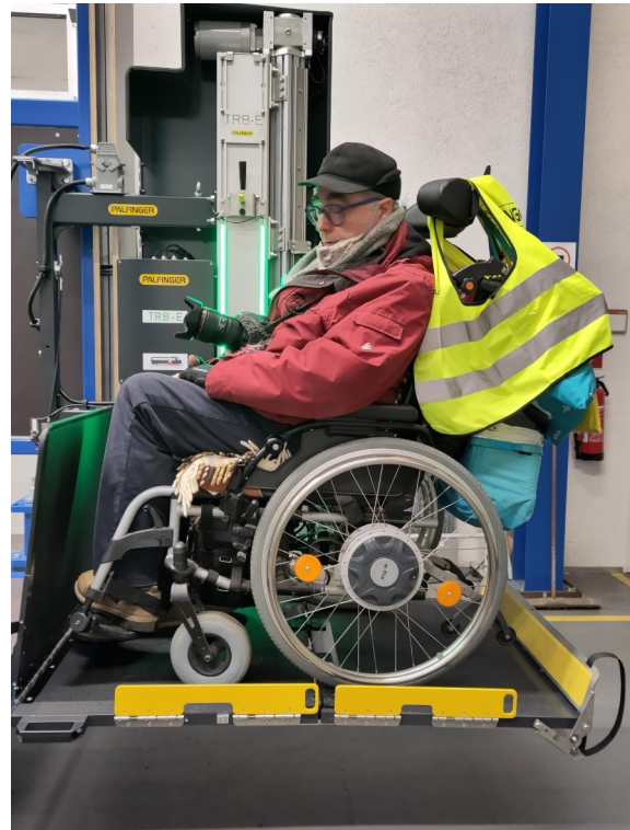
Test: kommen Rollifahrer mit der fahrzeuggebundener Einstiegshilfe (Hublift) in den Zug?
